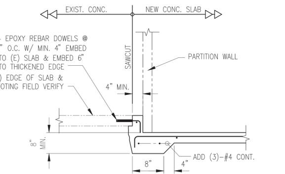
**11 DEPRESSED SLAB TO EXIST SLAB**
