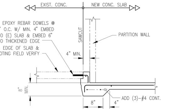
**11 DEPRESSED SLAB TO EXIST SLAB**
