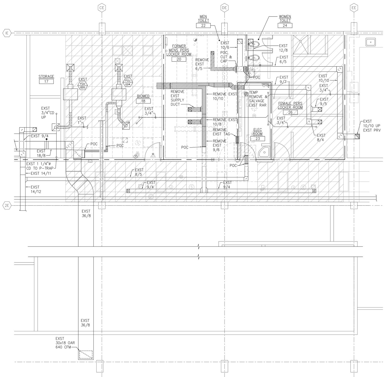
**MENS LOCKER DEMOLITION MECHANICAL PLAN**
