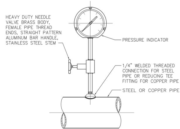
**2** ADJUSTABLE ANGLE PRESSURE GAUGE DETAIL
