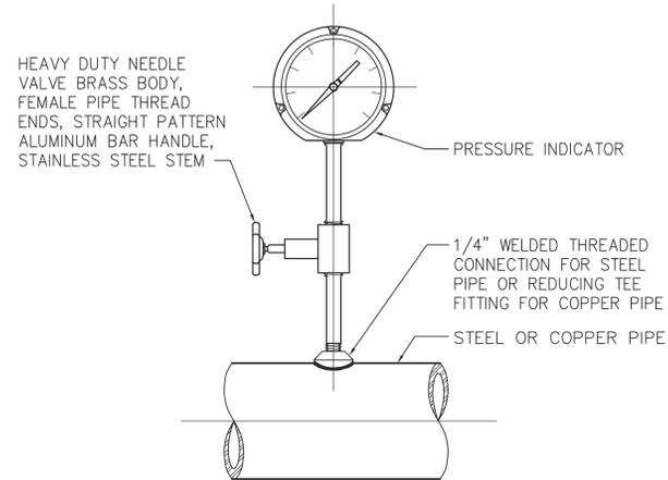
**2** ADJUSTABLE ANGLE PRESSURE GAUGE DETAIL
