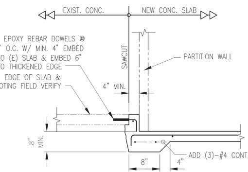
**11 DEPRESSED SLAB TO EXIST SLAB**
